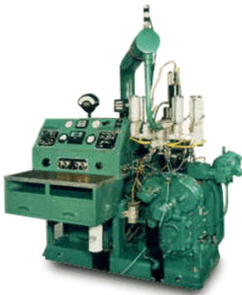
オクタン価の測定には CFR ENGINE<sup>2</sup>という特殊な試験エンジンを用います。このエンジンはアメリカの Waukesha Motor Co. で製造され Co-operative Fuel Research の頭文字をとって CFR ENGINE と呼ばれます。
